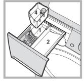
Esta función es útil para eliminar las manchas más resistentes. Introduzca la cubeta adicional 4 suministrada con la máquina, en el compartimento 1. Al dosificar el blanqueador, no supere el nivel "max" indicado en el perno central (ver la figura). Para realizar
